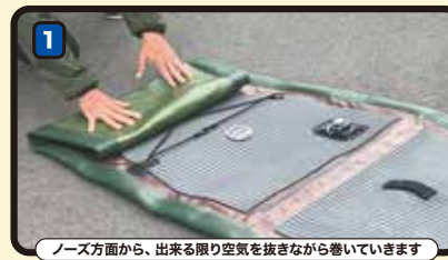
ノーズ方面から、出来る限り空気を抜きながら巻いていきます
