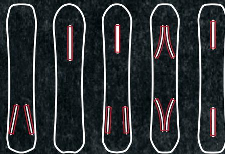
既存のホットロッドにオメガ・カーボンシートを追加し、それぞれの配置により反発力とレスポンスをアップさせる
