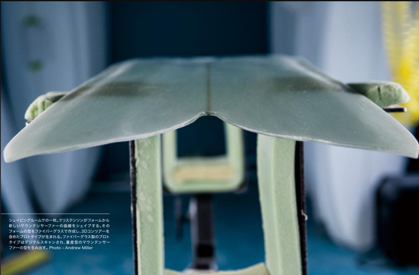
シェイピングルームでの一枚。クリステンソンがフォームから新しいマウンテンサーファーの曲線をシェイプする。そのフォームの型をファイバーグラスで作成し、3Dコンツアーを含めたプロトタイプが生まれる。ファイバーグラス製のプロトタイプはデジタルスキャンされ、量産型のマウンテンサーファーの型を生み出す。Photo - Andrew Miller
